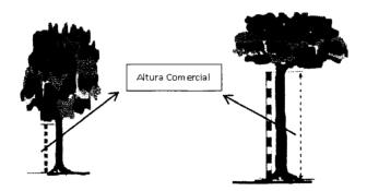
f: Factor de forma: es un ajuste que se da al árbol debido a su forma; Cilíndrica, paraboloide, cónica o neiloide, puesto que estas formas determinan el aprovechamiento máximo de este, por su uniformidad en el fuste y aprovechamiento máximo en el aserrado. Mientras más uniforme sea la forma del árbol, el factor de forma f se acerca más a la unidad y su aprovechamiento es máximo.
